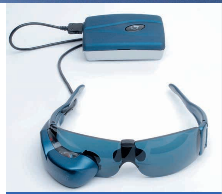
носимый миниатюрный жидкокристаллический дисплей Centra, фирма Eyetop
