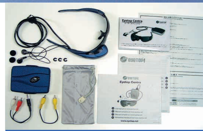
носимый миниатюрный жидкокристаллический дисплей Centra, фирма Eyetop
